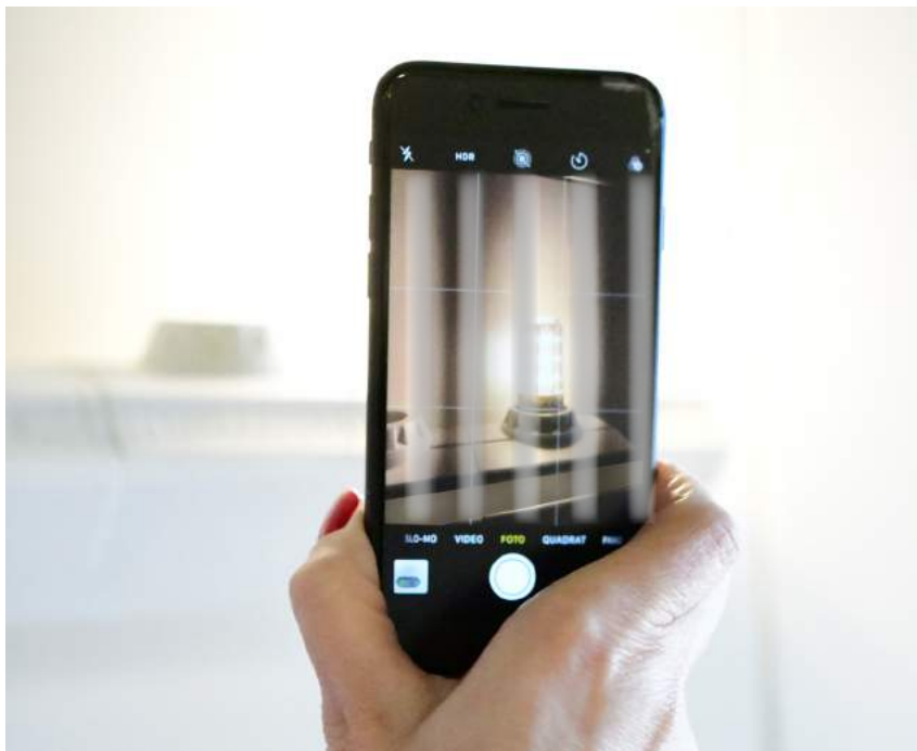
Flimmern im Handy-Display: Digitalkameras können typische Lichtprobleme bei LED-Lichtquellen entlarven.
